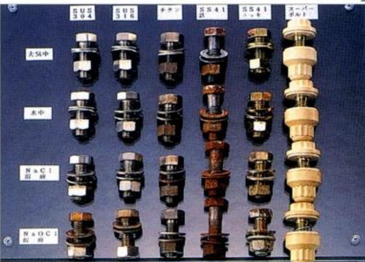
▲各種ボルトの耐蝕試験例
